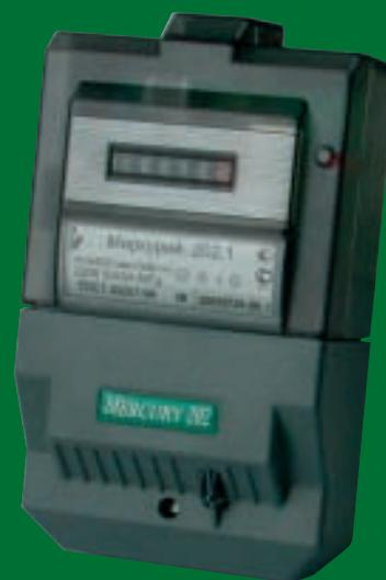
*Приборы обеспечивают дистанционный съем данных с использованием интерфейсов PLC, GSM, CDMA, CAN, IrDA, RS-485*
