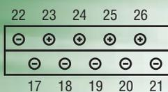
**Рисунок Г. 1** Расположение контактов колодки трёхфазных счётчиков «Меркурий 230» для подключения интерфейсов CAN, RS-485, импульсных выходов.
