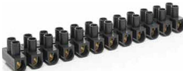
Предназначены для электрического и механического соединения (винтовое соединение проводников) медных и алюминиевых проводников со специальной или без специальной подготовки сечением от 1,5 до 35 мм<sup>2</sup> в цепях переменного и постоянного тока напряжением до 400 В.
