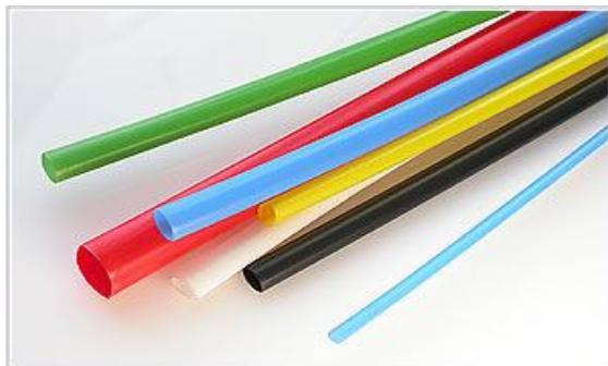
Тонкие термоусадочные трубки из полиэтилена обладают свойством подавления горения. Изделия обладают хорошими электрическими и механическими параметрами, применяются в качестве изолирующих и уплотняющих материалов. Усаживаются в два раза, принимая форму предметов.
