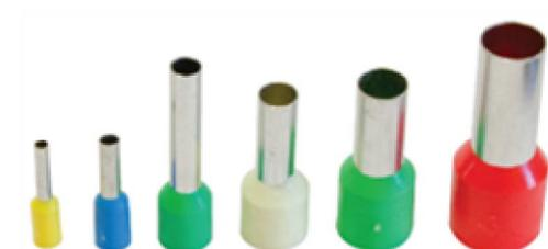
Предварительно зачищенная многопроволочная медная жила заводится внутрь втулки до упора. Затем втулочная часть наконечника опрессовывается поверх втулки специальным инструментом.
