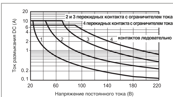
H 55 - Макс. отключающая способность DC1
